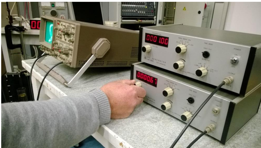
c) Lissajousove krivulje na osciloskopu
