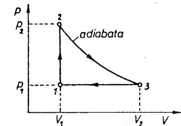
Pri prehodu  $1 \rightarrow 2$  plin prejme toploto  $Q_1 = mc_v(T_2 - T_1)$ , pri prehodu  $3 \rightarrow 1$  pa odda toploto  $Q_2 = mc_p(T_3 - T_1)$ :
