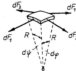
Največji dovoljeni tlak je pri enaki debelini stene in enaki snovi dvakrat večji kot pri valjasti posodi.
