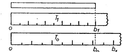
19.16. Živosrebrni termometer ima stekleno kapilaro z enakomernim presekom  $S$ . Pri temperaturi  $T_0 = 0^\circ\text{C}$  je bučka s prostornino  $V_0$  ravno polna. Do katere višine ( $h$ ) se dvigne živo srebro v kapilari, če termometer segrevemo do temperature  $T$ ? Temperaturni koeficient prostorninskega raztezka živega srebra je  $\beta$ , linearnega raztezka stekla pa  $\alpha$ .
