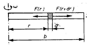
**6.21.** Centrifuga z epruvetami se vrta s krožno frekvenco  $\omega = 3600/\text{min}$ . Gladina vode v epruvetah je od osi odmaknjena za  $a = 7 \text{ cm}$ , dno epruvet pa za  $b = 15 \text{ cm}$ . Kolik je tlak ( $p$ ) na dnu epruvet?
