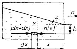
**18.2.** V levi krak U-cevi natočimo živo srebro, v desnega pa vodo. Dolžina živosrebrnega stolpca je  $b_1 = 10$  cm, vodnega pa  $b_2 = 8$  cm; razdalja med krakoma cevi je  $d = 2$  cm. Cev začnemo pospešeno pomikati v desno. Pri katerem pospešku ( $a$ ) sta gladini v obeh krakih enako visoko? Gostota živega srebra je  $\rho_1 = 13,6 \text{ g/cm}^3$ , gostota vode je  $\rho_2 = 1 \text{ g/cm}^3$ .
