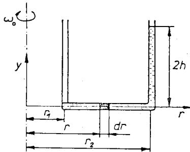
Če bi bil zunanji krak odprt, bi živo srebro v njem segalo do višine  $h_1 = \omega^2 h^2 / 2g$  (glej nalogo 6.9.). Ker je krak zaprt, je v točki 4 tlak  $p_4 = p_0 + \varrho gh_1 = p_0 + \varrho \omega^2 h^2 / 2 = 1,07 \text{ bar}$
