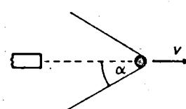
**21.34.** Reaktivno letalo leti z nadzvočno hitrostjo  $v = 680 \text{ m/s}$  v vodoravni smeri. Na kolikšni višini ( $h$ ) leti, če zaslišimo zvočni udar  $t = 6 \text{ s}$  kasneje, kot nas letalo preleti?
