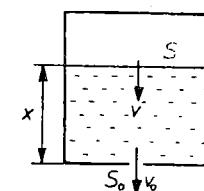
Iz obeh enačb izločimo  $v_0$  in izračunamo:  $v^2 = 2gx/(S^2/S_0^2 - 1)$ .
