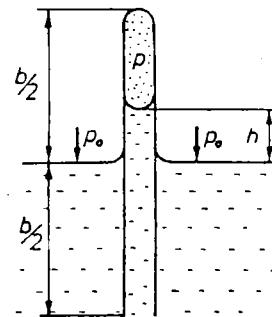
in od prvotnega tlaka  $p_0$  do prostornine  $S(b/2 - h)$  in tlak  $p$ . Ker se temperatura ne spremeni, velja:  $p_0 S b = p S(b/2 - h)$  ali:
