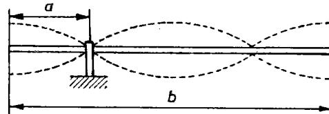
**21.48.** V Kundtovi resonančni cevi zbijamo longitudinalno valovanje z drgnjenjem jeklene palice (dolžina  $b = 1$  m). Ta oddaja osnovni ton s frekvenco  $v = 2480$  Hz. V cevi nastane stoječe zvočno valovanje, razmak med sosednjima vozloma je  $h = 6,9$  cm. Kolikšna je hitrost zvoka v palici ( $c_1$ ) in kolikšna v plinu ( $c_2$ )?
