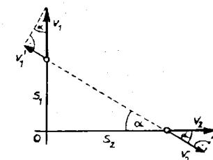
**21.31.** Poslušalec stoji na oddaljenosti  $d$  od ceste, po kateri vozi s hitrostjo  $v$  avtomobil s sireno, ki oddaja ton s frekvenco  $v_0$ . Kako se s časom spreminja frekvanca  $v$  zvoka, ki ga sliši poslušalec med približevanjem avtomobila in kako med oddaljevanjem?
