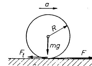
9.14. Enaka valja (masa  $M = 2\text{kg}$ , polmer  $R = 10 \text{ cm}$ ) sta pritrjena na skupno os z maso  $m = M/2$  in polmerom  $r = R/2$  in ležita na vodoravni podlagi. Na osi je navita vrv, katere konec vlečemo s stalno silo  $F = 5,0 \text{ N}$  pod kotom  $\varphi = 60^\circ$  glede na navpičnico. S kolikšnim pospeškom ( $a$ ) se giblje os valja v vodoravni smeri? Kolikšen mora biti statični torni koeficient ( $k_s$ ) med tlemi in valjem, da valja ne podrsuje?
