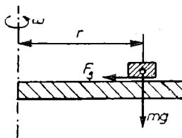
**6.6.** Vodoravna plošča se vrvi okrog navpične geometrijske osi s stalno kotno hitrostjo  $\omega$ . Na plošči leži telo z maso  $m$ , ki je prek škipca na osi povezano z visečo utežjo (masa  $M$ ). Pri katerih oddaljenostih ( $r_1$  in  $r_2$ ) od osi je telo na plošči v ravnotesju? Statični torni koeficient med telom in ploščo je  $k_s$ .
