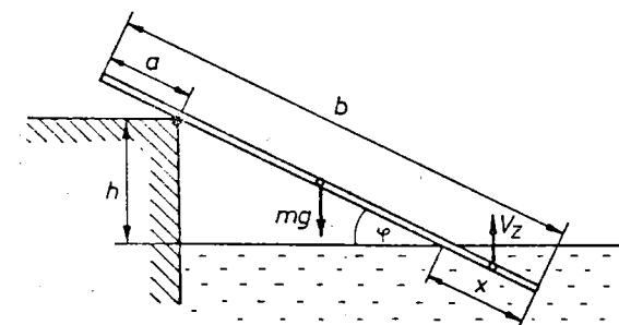
Navor teže palice glede na vodoravno os skozi rob pomola je enak navoru vzgona, ki deluje na potopljeni del palice; zadnji ima prijemališče v težišču potopljenega dela palice.
