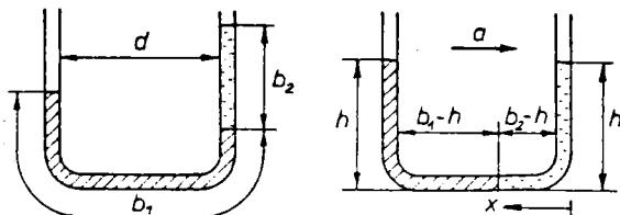
V spodnjem delu mirujoče cevi se tlak ne spreminja v vodoravni smeri. Brž ko cev pospešeno potiskamo v desno, se tlak v levi smeri povečuje, saj je potrebna tlačna razlika za pomikanje tekočine v desno. Na mestu  $x = 0$  (v vznožju desnega kraka, kjer je voda) je tlak enak  $\rho_2 gh$  (zunanjega tlaka ne upoštevamo, ker sta obo kraka cevi
