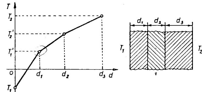
V vsaki posamezni plasti se temperatura linearno spreminja z globino  $d$ . Temperaturi na stiku sosednjih plasti sta  $T'_1$  in  $T'_2$ . Skozi vsako plast teče enak topotni tok:
