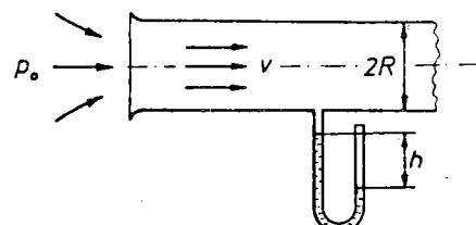
**18.18.** Kolik je pretok ( $\Phi_v$ ) zraka skozi Venturijev cev, če priključeni vodni manometer kaže višinsko razliko  $h = 10 \text{ cm}$ ? Premer širšega dela cevi je  $2R_1 = 1 \text{ cm}$ , premer ožjega dela pa  $2R_2 = 0,5 \text{ cm}$ . Gostota zraka je  $\rho = 1,2 \text{ kg/m}^3$ , gostota vode je  $\rho_v = 1 \text{ g/cm}^3$ .
