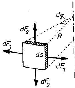
Navpična sila  $dF_2$  je posledica sile  $p\pi R^2$ , s katero plin odriva zgornjo ploskev posode. Ta sila se porazdeli po prečnem prerezu valjastega plašča ( $2\pi Rh$ ). Na ločni element  $Rd\varphi$  deluje sila  $dF_2 = p\pi R^2 Rd\varphi / 2\pi R = pR^2 d\varphi / 2 = \sigma_2 hRd\varphi$  ali
