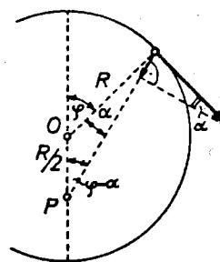
**21.33.** Krogle zapusti puškinu cev s hitrostjo  $v = 720 \text{ m/s}$ . Kolikšen kot ( $\alpha$ ) oklepa udarni zvočni val s smerjo gibanja krogle?
