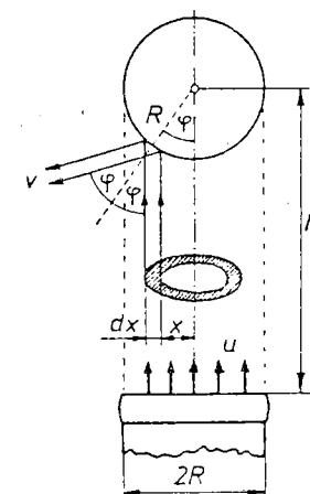
**7.30.** S kolikšno hitrostjo ( $u$ ) mora helikopter z vodoravnim propelerjem potiskati zrak navzdol, da lebdi v zraku? Masa helikoptera je  $M$ , polmer propelerja je  $R$ , povprečna gostota zraka je  $\rho$ .
