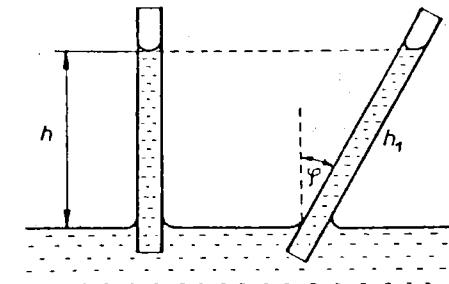
Polovica dela sile površinske napetosti se naloži kot potencialna energija dvignjene vode, druga polovica se porabi za premagovanje trenja in upora med dviganjem. Višinska razlika dvignjene vode je neodvisna od nagiba kapilare, zato je  $h_1 = h/\cos\varphi = 10,3 \text{ cm}$ .
