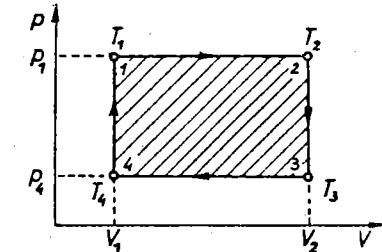
Množino plina (masa  $m$ ) izrazimo z začetnim tlakom in začetno temperaturo:  $p_1 V_1 = nRT_1 = m(R/Mkg)T_1 = m(c_p - c_v)T_1 = mc_v(\alpha - 1)T_1$  ali  $m = p_1 V_1 / [c_v(\alpha - 1)T_1]$ .
