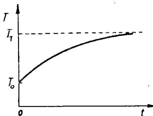
**20.32.** V topotno izolirani posodi je  $m_0 = 300 \text{ kg}$  vode s temperaturo  $T_0 = 20^\circ\text{C}$ . V posodo spuščamo nasičeno paro s temperaturo  $T_1 = 100^\circ\text{C}$ , masni tok je  $\Phi_m = 200 \text{ kg/h}$ . Močno mešamo, da je temperatura v posodi enakomerna. Kako se spreminja s časom? V kolikšnem času ( $t_1$ ) se voda segreje do temperature  $T_1$ , dotečajoče pare? Koliko tekoče vode ( $m_1$ ) ostane v posodi?
