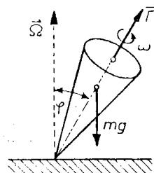
**10.19.** Prednje kolo bicikla ima povprečen polmer  $R = 32$  cm, okvir kolesa z gumo vred ima maso  $m = 2,5$  kg. Kolo se giblje s hitrostjo  $v = 20$  km/h (težišče). Poišči izraz za navor  $M$ , s katerim vrteče se kolo deluje na volan, če se bicikel začne nagibati s kotno hitrostjo  $\Omega = 0,3/s$  na stran.
