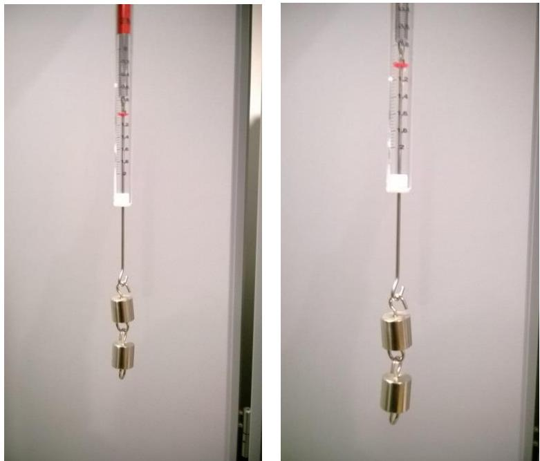
**ravnovesje sil** - tri vzetne tehnice/dinamometri + uteži
