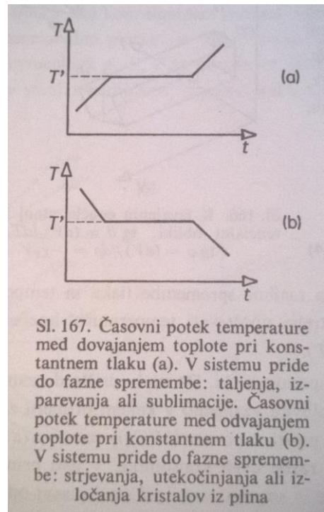
Sl. 167. Časovni potek temperature med dovajanjem toplote pri konstantnem tlaku (a). V sistemu pride do fazne spremembe: taljenja, izparevanja ali sublimacije. Časovni potek temperature med odvajanjem toplote pri konstantnem tlaku (b). V sistemu pride do fazne spremembe: strjevanja, utekočinjanja ali izločanja kristalov iz plina
